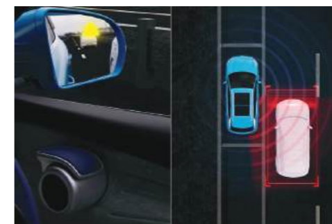
DOOR OPEN WARNING (DOW)
